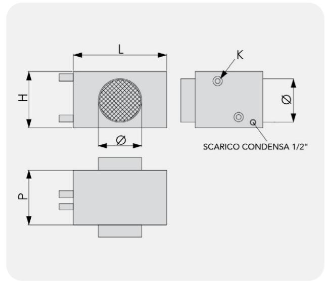
Le batterie da canale sono concepite per essere inserite negli impianti di ventilazione e permettono di integrare potenza sensibile in caldo e/o in freddo.
